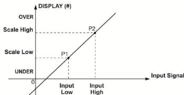
**Fig. 17** - SCALE Function (LINEAR)
